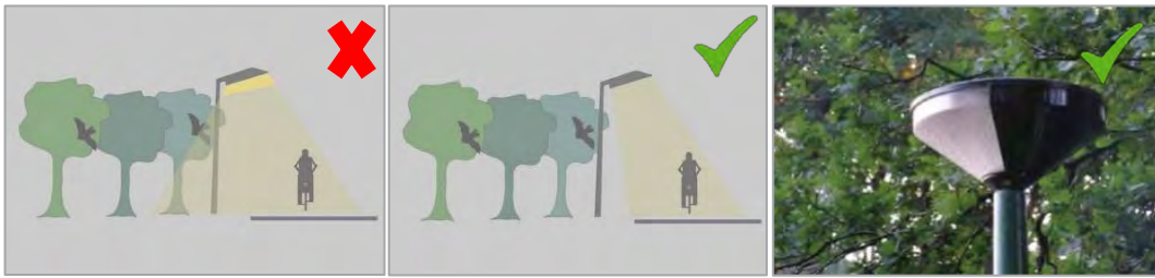
Figuur 5.2 Voorbeeld van armaturen met een scherpe 'cut-off'.
