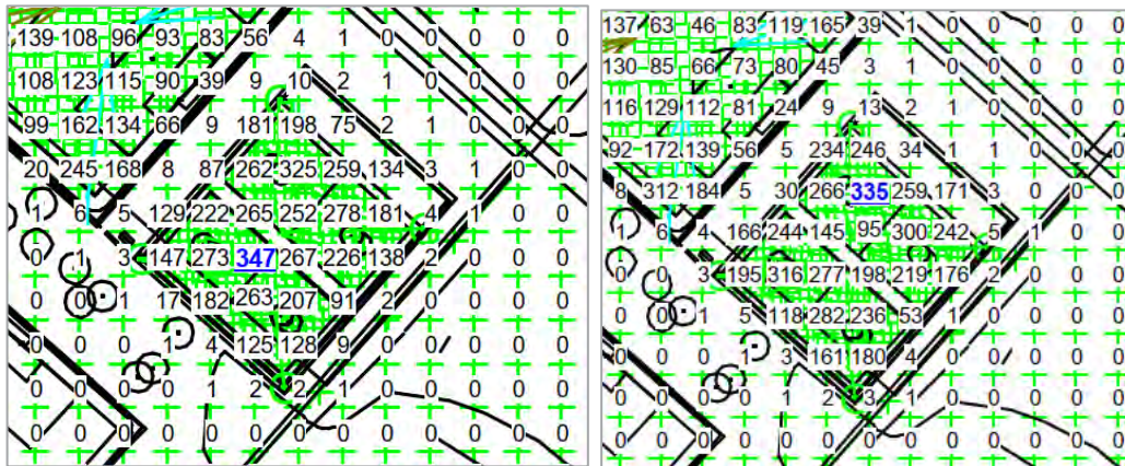
Figuur 2.2 Grafische tabel van de (vlak-)verlichtingssterkte (lux) op 0,0 m (links) en 1,80 m (rechts) in de toekomstige situatie (Veldhuizen 2021). De nummers buiten dit veld geven aan hoeveel verlichting (lux) er op de omgeving schijnt op een hoogte van 0,0 en 1,80 m.
